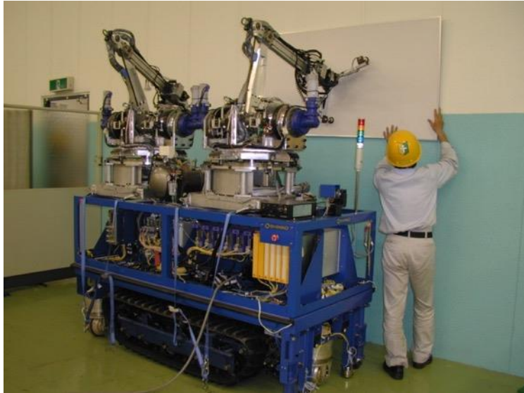
双腕マニピュレータによるパネルの協働 ハンドリング
