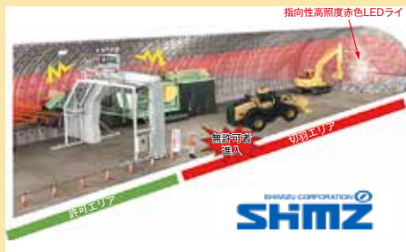
図表 1-5 「Safety 2.0 技術認証」を受けた、ずり出し時の安全方策システム (筆者作成)
