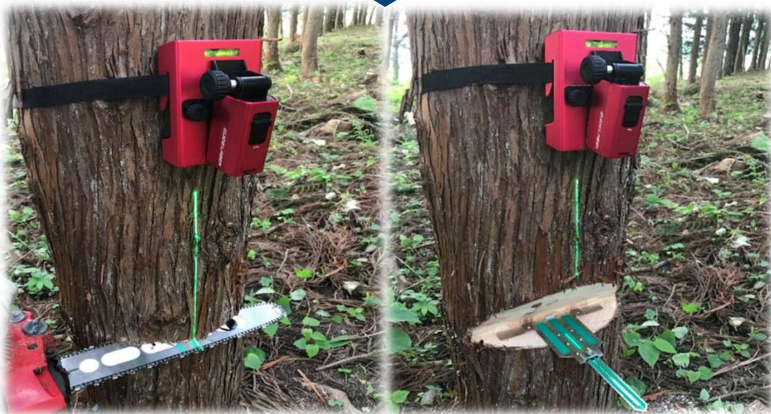
ガイドレーザーは、チェーンソーによる伐倒作業において、伐倒方向・立木の傾き・倒す方向に対して直角なチェーンソーの切り口をラインレーザーで示し可視化することで、伐倒方向に正確な受け口を作成するための補助装置。
