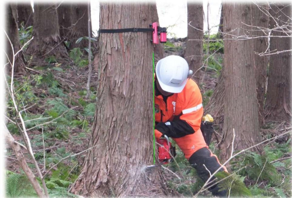
伐採作業における補助装置ガイドレーザー・ガイドレベルの開発目的は「かかり木」が原因による労働災害・死亡事故の撲滅が根本にあります。チェーンソーによる伐採作業では、倒した樹木が周りの木々に引っかかり下まで落ちてこない状況を業界では「かかり木」というが、この状態が一番危険とされ発生するとその状態の解消・修復作業に極めて危険な工程作業を余儀なくされる。
