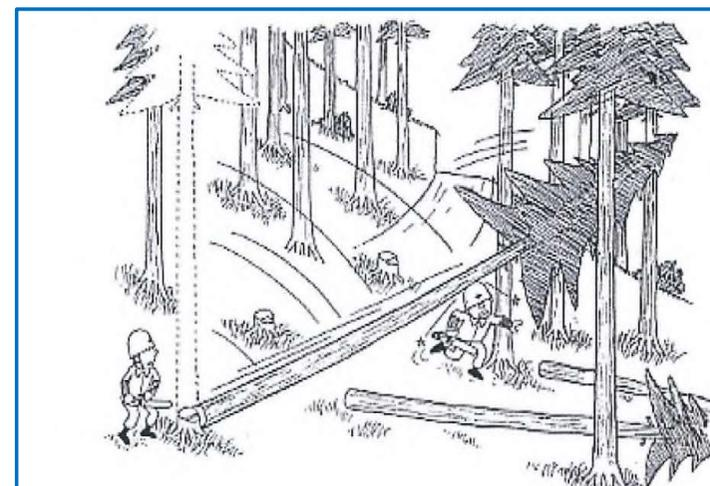
林道開設工事に伴う支障木の伐採作業中、スギ立木を伐倒したところ伐倒方向が変わり、既に作業が終わり斜め下方に退避していた同僚の頭部に激突した。
