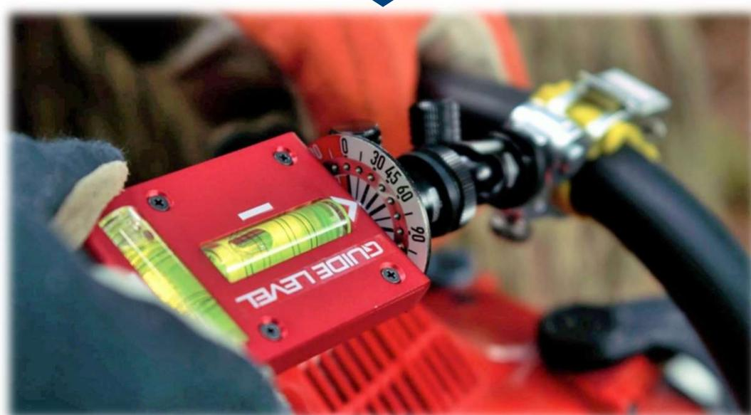
ガイドレベルは、チェーンソー作業において状況に応じて使用したい角度に角度板を設定することで、作業しながらでもチェーンソーガイドバーの角度確認を可能とする角度指示器付き水平器。
